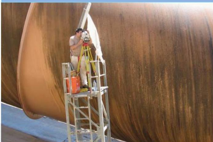
Medição: método com o teodolito
